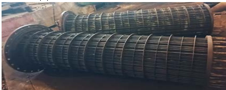
Fig. 1. Haz de tubos internos del intercambiador de calor donde se observan los deflectores del lado del aceite. Fuente: autores
